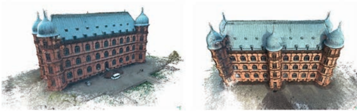
Bild 2: 3D-Punktwolke mit Bildtextur des Schlosses Gottesau, erzeugt mit der Software SURE.
