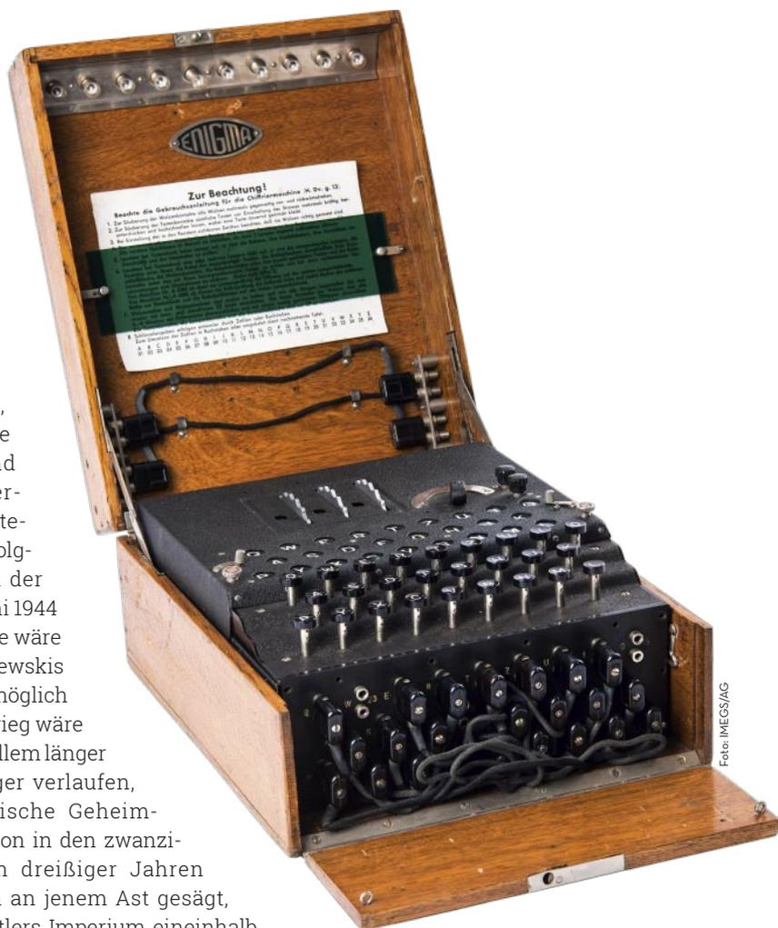
Klar zu erkennen die Tastatur, darunter die Verschlüsselungseinheit. Im Bild im aufgeklappten Deckel auszumachen: das Lampenfeld.
